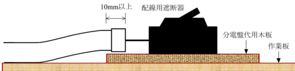
※管端ブッシングが 10 mm 以上、木板に乗っていること。また分電盤代用木板に接触しないように施工すること。
