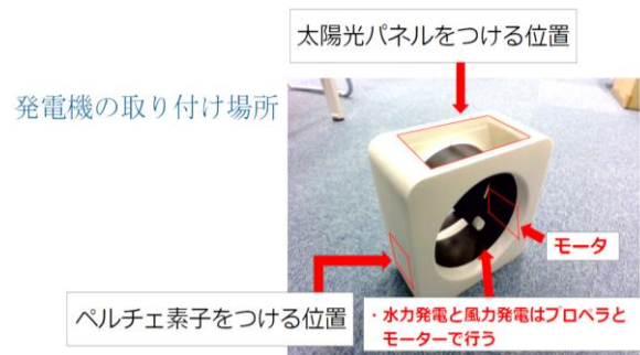
図 12 各発電機の取付位置
